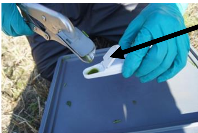
Nitrat-indhold aflæses på Horiba sensor (990)
