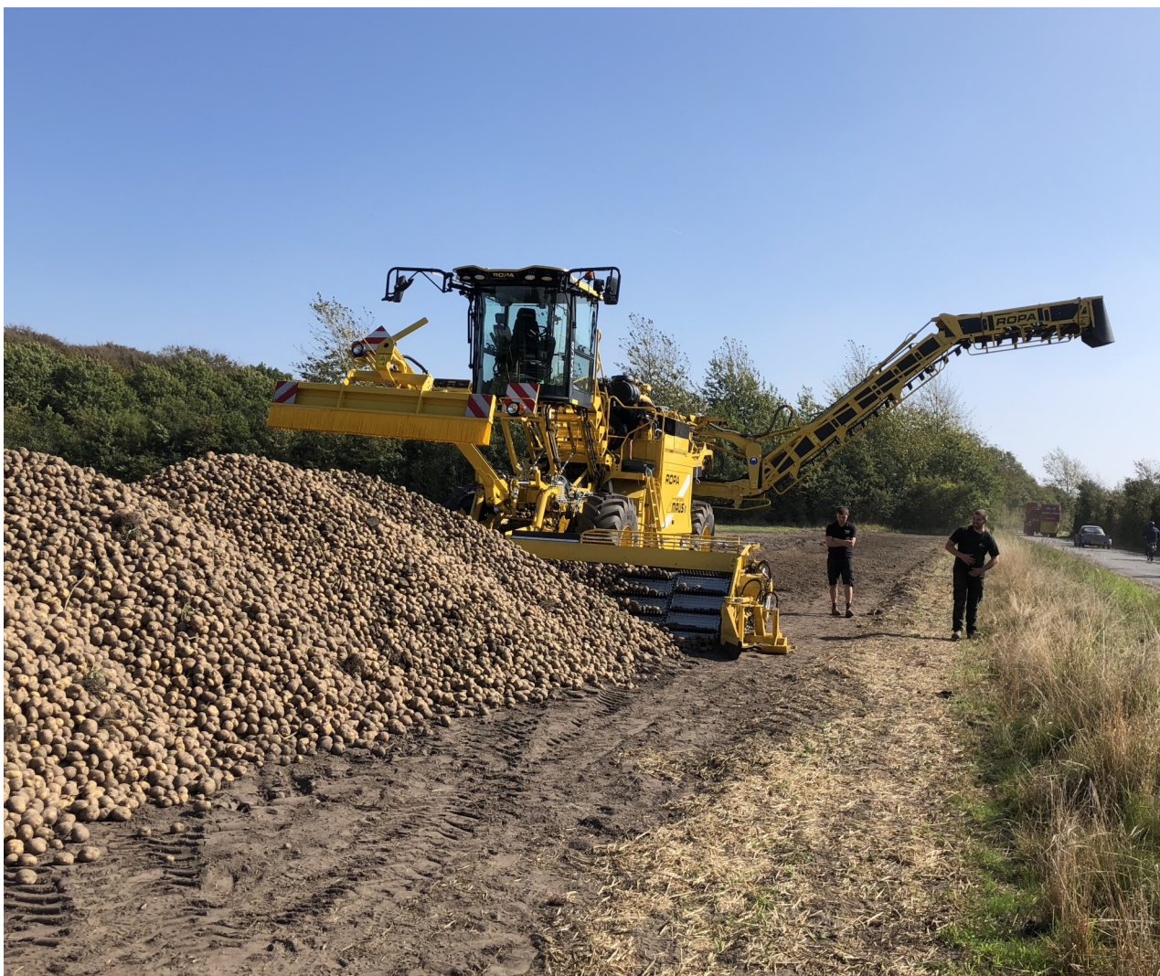
Læsse-/rensemaskine på prøve i efteråret
